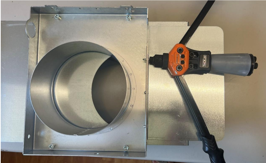
Abb. 5: Befestigung des Handschutzes mit Blindnieten
