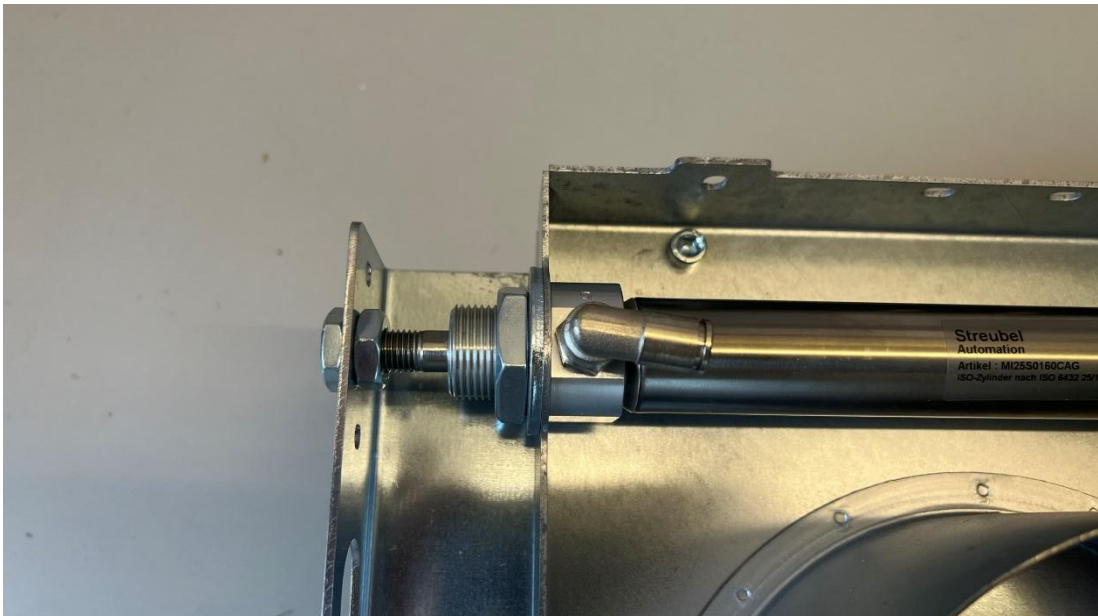
Abb. 7: Verbindung Schieberblech – Zylinder
