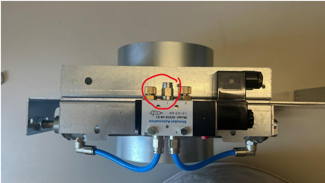
Abb. 13: Einstellung der Drosselschalldämpfer
